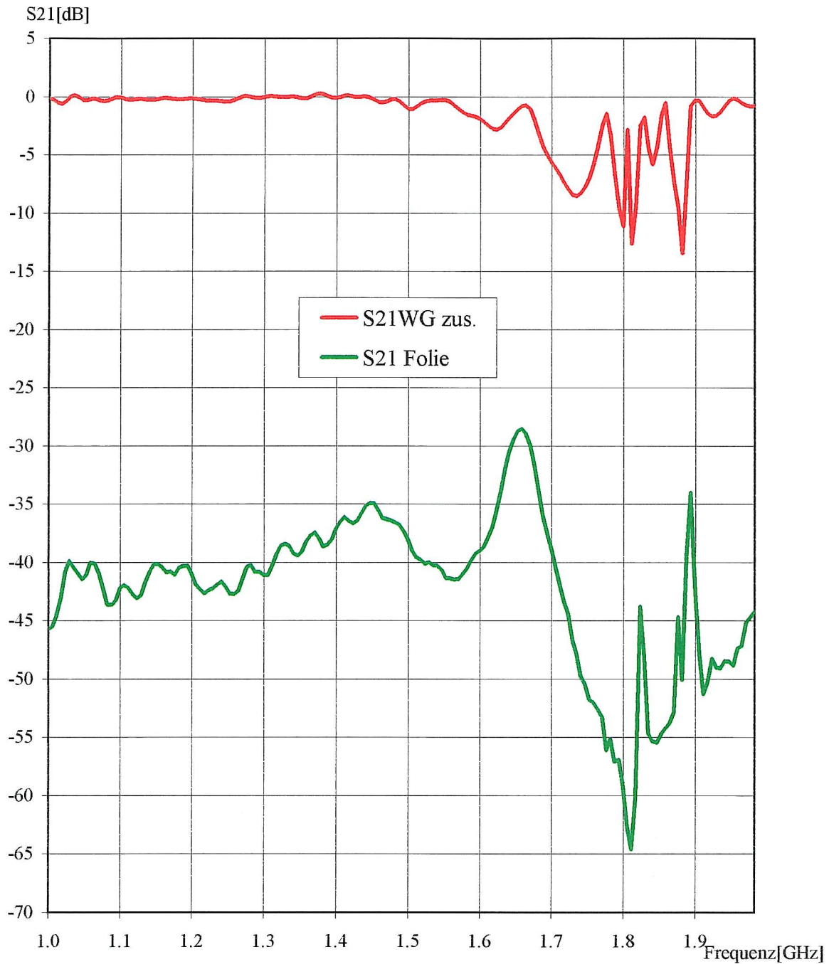
Abb. 1: Transmissionsspektren von Hohlleiter (WG) und Folie zwischen den Hohlleitern
